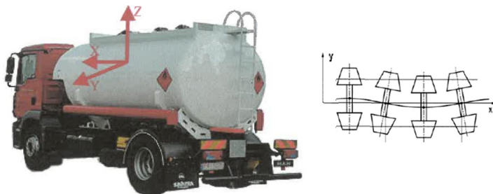
Rysunek 1. Układ współrzędnych pojazdu oraz schemat wężykowania jako niestateczności ruchu zestawu kołowego w sztywnym torze
